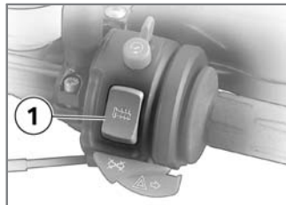
1 Commutateur de chauffage des poignées
