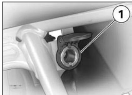
Si la tension de la batterie est trop faible, de même qu'en cas de dépassement de l'ampérage maximal admissible, la prise électrique **1** et la prise électrique livrable à titre d'accessoire (AO) sont automatiquement coupées.
