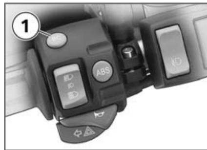
Sur les modèles avec ordinateur de bord, la touche BC (Ordinateur de bord) **1** remplace la touche TRIP (Trip-master) sur le commodo.
