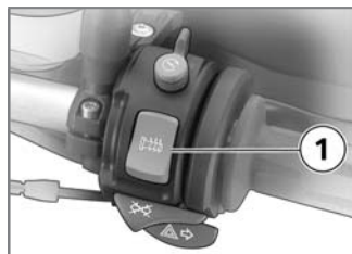
1 Commutateur de chauffage des poignées
