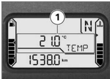
Lorsque la moto est à l'arrêt, la chaleur du moteur peut fausser la mesure de la température ambiante **1**. Si l'influence de la chaleur du moteur est trop grande, le système affiche provisoirement -- sur le visuel.
