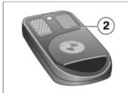
La durée de l'alarme est de 26 secondes. L'installation est à nouveau active après 12 secondes supplémentaires. Une alarme déclenchée peut être interrompue à tout moment par une pression sur le bouton **2** de la télécommande. Cette fonction ne modifie pas l'état de l'alarme antivol.
