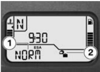
Le réglage de l'amortissement s'affiche dans la zone 1 et la précharge des ressorts dans la zone 2 du visual multifonctions.
