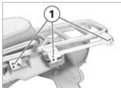
Le porte-bagages comporte au niveau des points de fixation 1 deux orifices superposés. Lorsque l'on utilise à l'avant et à l'arrière les trous situés à des hauteurs différentes, le support de top case est, suivant la configuration, incliné vers l'avant ou vers l'arrière. En combinaison avec le dossier disponible en tant qu'accessoire optionnel, le top case peut être utilisé en tant que soutien dorsal.
