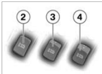
Le chauffage des poignées du guidon est à deux niveaux. Le deuxième niveau sert pour le réchauffement rapide des poignées ; ensuite la commutation devrait à nouveau s'effectuer vers le premier niveau. Il ne fonctionne que si le moteur tourne.
