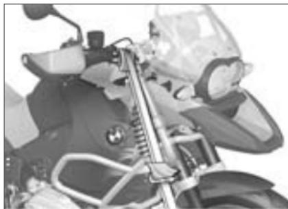
**⚠** Des composants peuvent être endommagés. Ne coincer aucun composant tel que conduite de frein ou faisceau de câbles.◀
