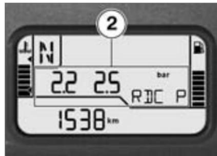
Les pressions de gonflage des pneus affichées 2 se réfèrent à une température de pneu de 20 °C. La valeur de gauche représente la pression de gonflage de la roue avant et la valeur de droite celle de la roue arrière. Au démarrage, --- s'affiche immédiatement : la transmission des valeurs de pression de gonflage ne commence qu'une fois que le véhicule a dépassé la vitesse de 30 km/h.
