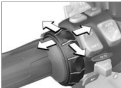
La commande du Multi-Controller est assurée par six mouvements :
