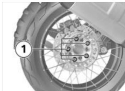
**!** Les longueurs des vis de la roue à rayons et de la jante en fonte sont différentes. Un mélange ou une inversion des vis de roue détériore la fixation de la roue arrière et entraîne en conséquence un risque d'accident.
